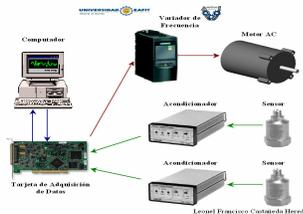
Para evaluar la severidad de la vibración de máquinas rotativas. Normas ISO 2372, ISO 10816 – 3.
