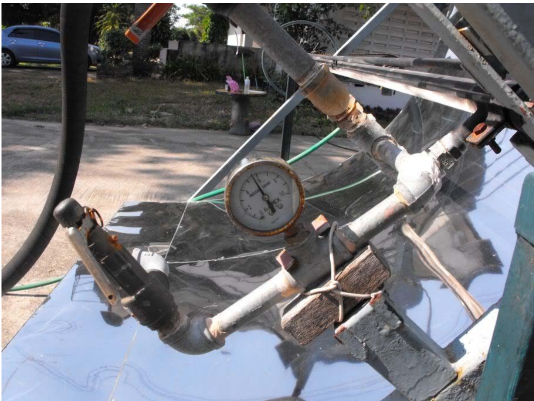
El evaporizador de la bomba Solex con una presión del vapor alrededor de 5 bar bajo la radiación solar idonéa
